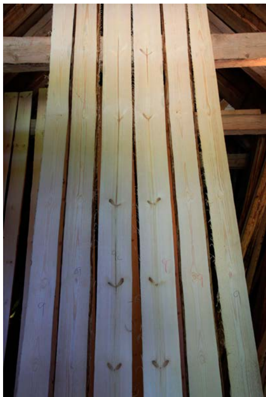
Figur ST11 Stamkvistad tall som är 50 år, här genomsågad i demonstrations- syfte. Helt kvistrent virke har bildats utanför diametern 12 cm. Foto Bo Jonasson.
