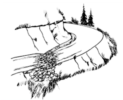
Figur 14. Stenränna som fungerar som korsdike och trumma. Efter Fergus et al (2011).
