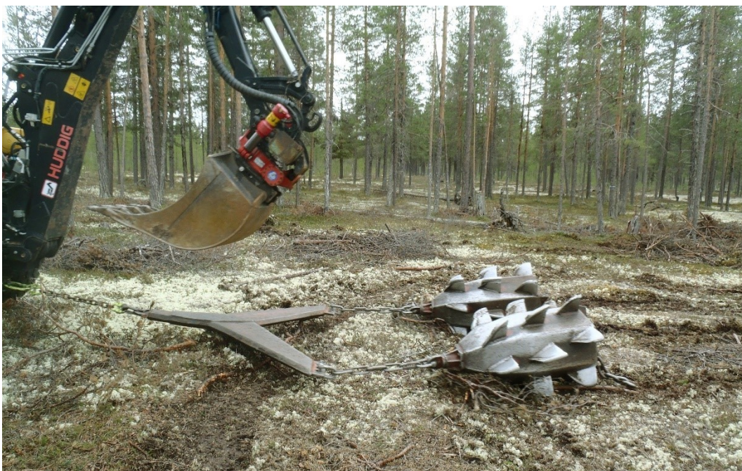
Bild 8: De s.k. "kloten" kopplade till en Huddig traktorgrävare.
