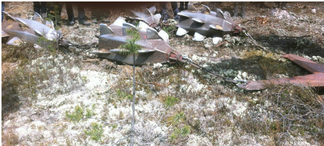
Bild 1: Stora Ensos egenutvecklade s.k. ”klot” för skonsam markberedning.
