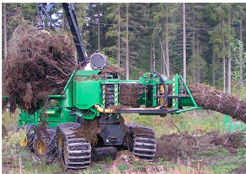
Figur SB16 Grothögar efter bränsleanpassad avverkning komprimeras till grotstockar. En av fördelarna med systemet är att grotstockarna kan transporteras med konventionell transportutrustning för rundved. Foto Gustaf Egnell.
