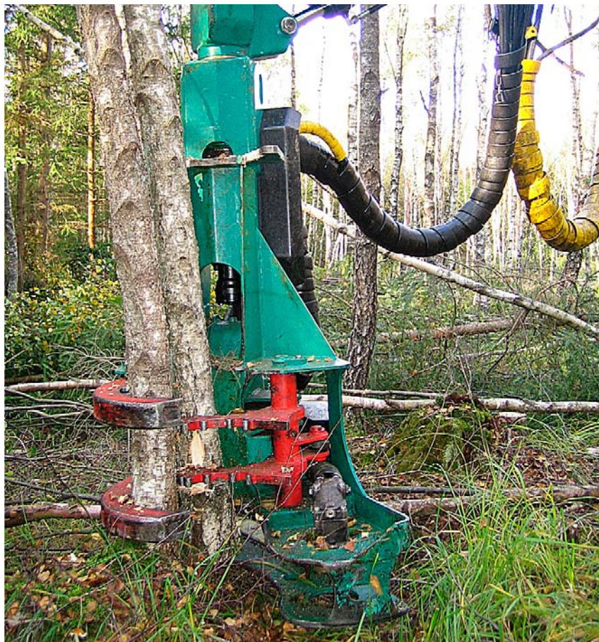
Figur SB19 Ett av flera flerträdshanterande fällhuvuden under utveckling. Foto Anders Nilsson.
