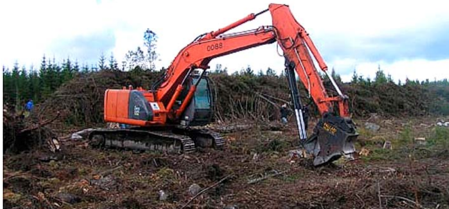
Figur SB17 Dagens stubbskördare med ett specialgjort stubbskördarhuvud på en konventionell grävmaskin. Foto Gustaf Egnell.
