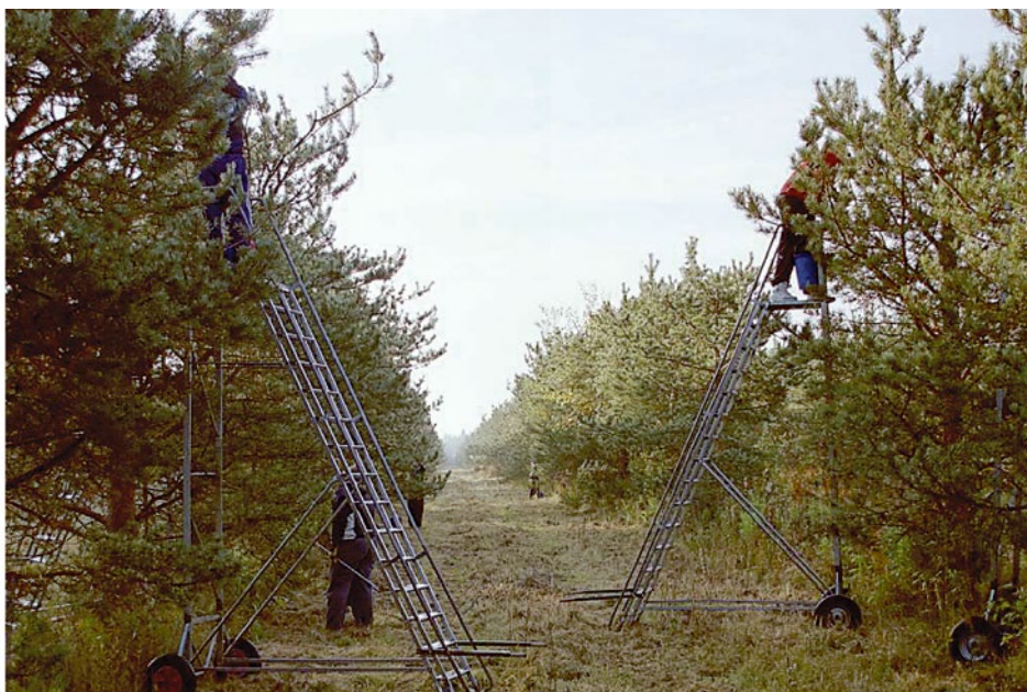
Figur FP18 Arbetsplattform på hjul möjliggör en säker kottskörd i plantage T7 Slåttholmen. Foto Ulfstand Wennström.
