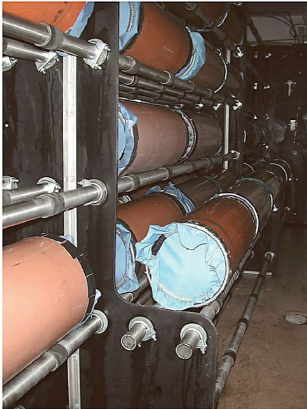
Figur FP24 Frön under vitalisering på ställning med automatiserad rullning. Foto Ulfstand Wennström.
