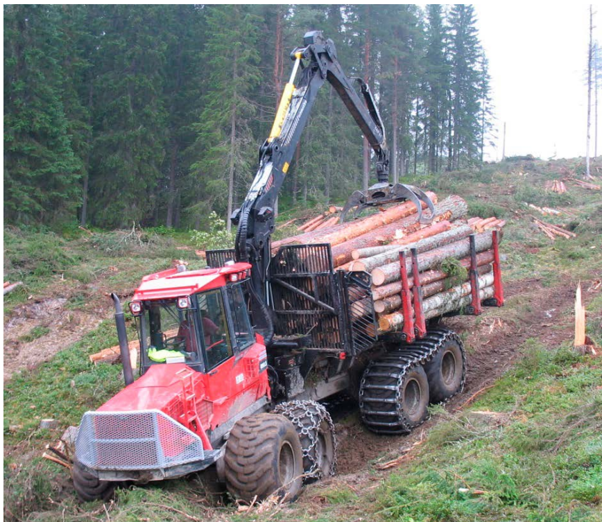
Figur SA23 Skotaren är den maskin som används för att transportera ut stockar och grot till avlägg. På bilden syns en Komatsu 890.3. Foto Ola Lindroos.
