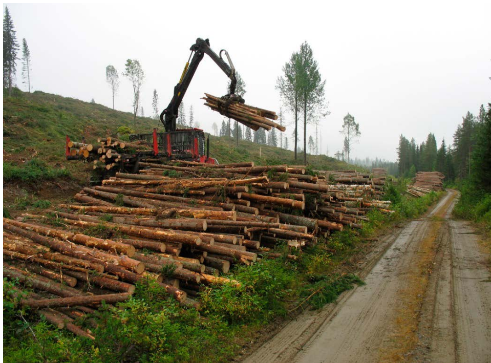
Figur SA18 Avlägg längs skogsbilväg, med olika sortiment i separata högar (vältor) längs vägen. När vägen går i direkt anslutning till beståndet blir avläggsplaceringen lättplanerad och ger gott om utrymme. Foto Ola Lindroos.
