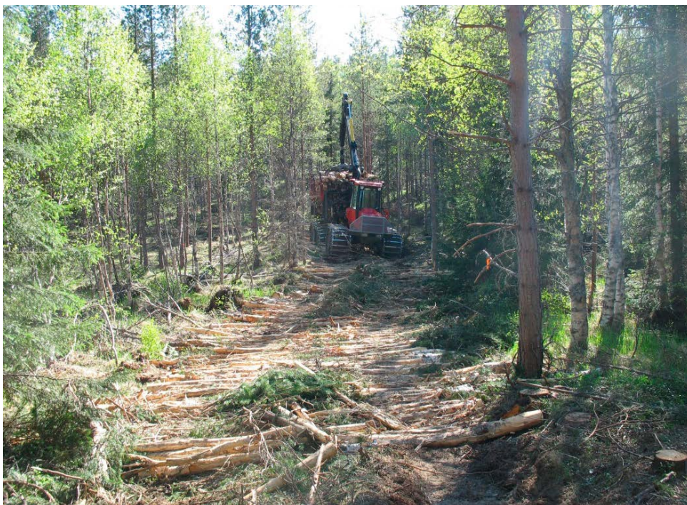
Figur SA31 Område kring bäcköverfart som har förstärkts genom utläggning av stockar och grot. Foto Ola Lindroos.
