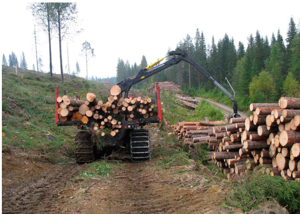
Figur SA32 Skotare som lastar av från skogssidan i stället för att köra på bilvägen under avlastningen. Vägen förstörs då inte av skotarens band. Foto Ola Lindroos.
