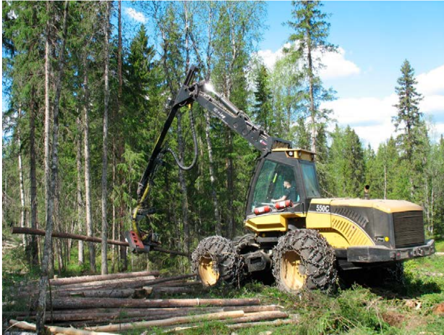
Figur SA22 Skördaren är den maskin som används för att fälla, kvista och kapa trädet till stockar. På bilden syns en Ecolog 550C med ett Logmax 4000B aggregat. Foto Ola Lindroos.
