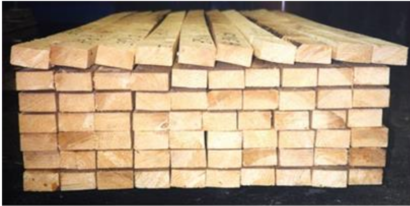
Figur V32 Ett virkespaket med regler som torkats i en konventionell kammartork under hög belastning. Reglarna i alla lager har haft samma förhållanden under torkning och lagring. Det övre lagret utgörs av regler sågade från en gran med extremt stor växtvridenhet. De övriga sex lagren innehåller regler från fyra normalt växtvridna granar. Foto Harald Säll.
