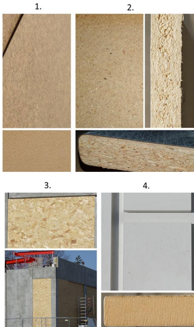
Figur V46 Från vänster: 1. En hårdpressad boardskiva (fram och baksida; typen av skiva är känd i Sverige under varumärket Masonit). 2. En spånskiva uppifrån och i två olika tvärsnitt. 3. OSB-skivor som gjutformar. 4. MDF-skiva fräst och målad yta, respektive omålade genomskärning. Generellt för de olika typerna av skivor är att vedens ursprungliga egenskaper har mindre betydelse än i solida trävaror. Däremot är lim, fyllnadsmaterial, värmebehandling, kompression, med mera, i tillverkningsprocesserna desto viktigare. Eftersom behandling mot bland annat fukt och mögel utgör miljöproblem (till exempel formaldehyd) kan både råvarans egenskaper och biobaserade lim, fyllnadsmaterial med mera få ökad betydelse framöver. Foton: Lars Wilhelmsson.
