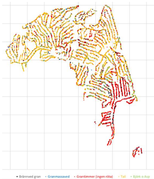
Figur VII15 Karta visande skördarens uppställning och sortimentstillredning från rotstockar fördelade på trädslag och sortimentsgrupper. Andelen rotstockar av gran som nedgraderats till brännved på grund av rotröta och vid lindriga rötangrepp till granmassaved syns tydligare i figur Sort-Röt (avverkningstrakt i Labbo, Norduppland, skörd 2016). Bild Lars Wilhelmsson.
