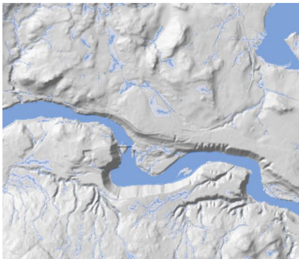
Figur 40. Höjddata indikerar områdets känslighet för erosion och ras.
