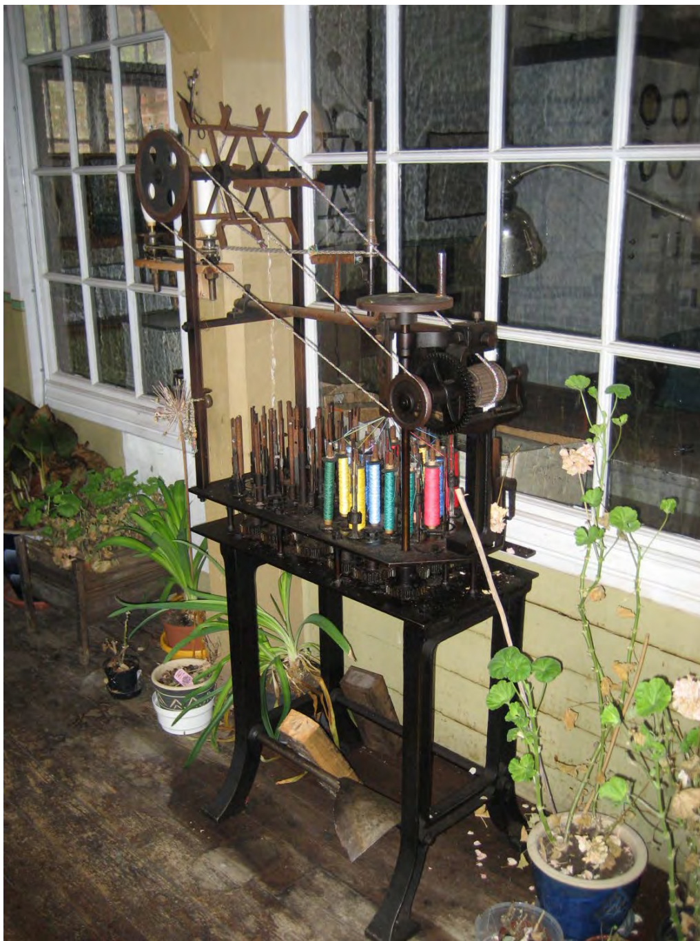
Bild 9. Den sinnrika trådrullemaskinen, där 32 stycken trådrullar kunde tillverkas samtidigt. Foto: Petra Stråkendal.
