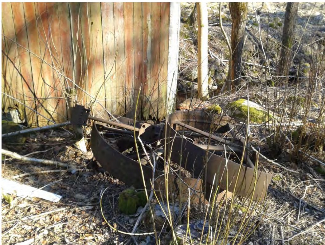
Bild 2. Maskindelar utanför kraftverket. Detta är ett hjul för remdrift. Utrustningen inuti är förstörd eller försvunnen. 2008 när kraftverket besöktes vid den tidigare inventeringen av Mieån, så fanns det mer kvar av den maskinella utrustningen.
