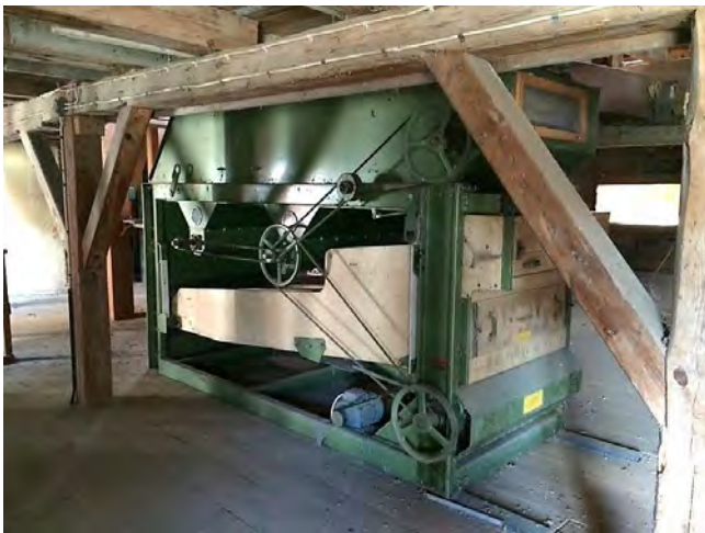
Bild 6. Rensmaskin i tröskverksbyggnaden.
