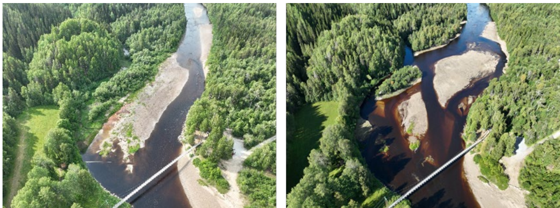
Figur 12. Storskalig restaurering i Lagnäset Öreälven, Bjurholms kommun där bilden till vänster visar sträckan före åtgärd och bilden till höger visar efter åtgärd då stora massor har flyttats och nya fåror/öar har skapats. Här fotograferats uppströms från 75 meters höjd. Foto: Jonathan Nordin.
