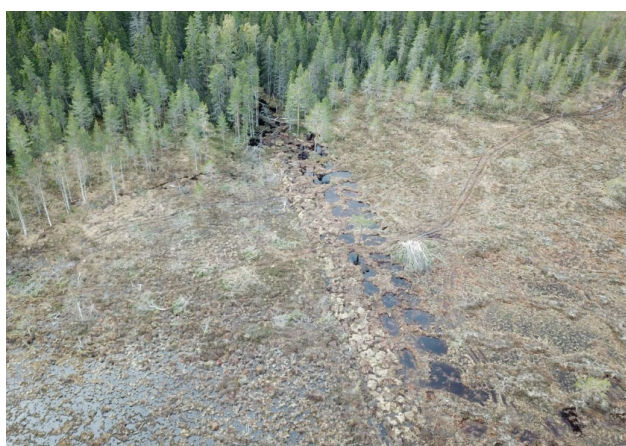
Figur 16. Till vänster: Igenlagt dike där materialet har tagits i gropar. Foto: Tobias Eriksson. Till höger: Skiss på grop i genomskärning och gropens utseende efter att man lagt material i botten och släntat av kanterna.
