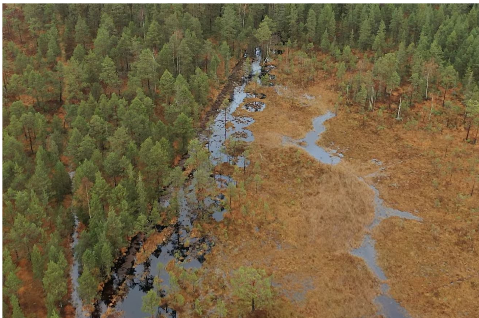
Figur 8. Till vänster i bild syns diket som lagts igen med dikespluggar ungefär var 50 m. Vattnet rinner nu, i stället för i diket, långsammare på bredden och något "meandrande" över våtmarken. Foto: Sverker Johansson/Bitzer Produktions AB
