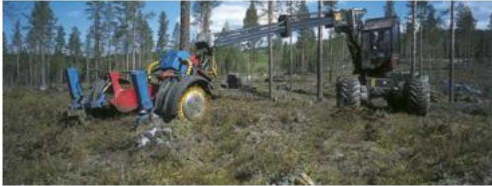
Figur NF30 Kranspetsmonterat aggregat för markberedning och sådd – ”Humax 2–4”. Foto Holmen Skog AB.
