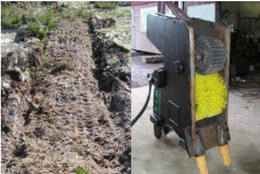
Figur NF29 Exempel på ett aggregat – ”Eco seedplanter” – med skonsam markberedningsteknik för torra marker. Markberedningen skapas i detta fall med en roterande plastborste. Aggregatet på fotot är även försett med ett mikroprepareringshjul och såddmatning. Foto Bror Österman.
