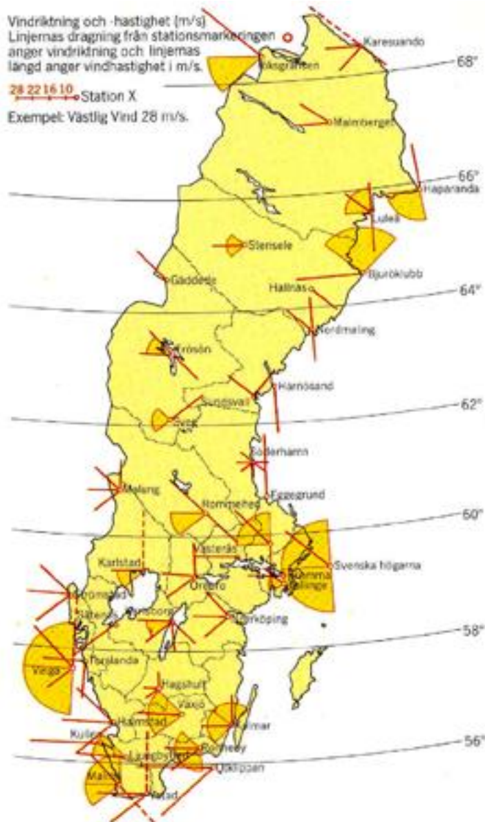
Figur NF45 Vindriktningar och vindhastigheter vid de högsta observerade vindhastigheterna 1949–1969. Cirkelbågar anger dominerande vindriktningar (varifrån vinden kommer) vid de högsta vindhastigheterna. De dominerande vindriktningarna i Sverige är väst-nordväst. Linjernas längd anger vindhastighet. 327,328
