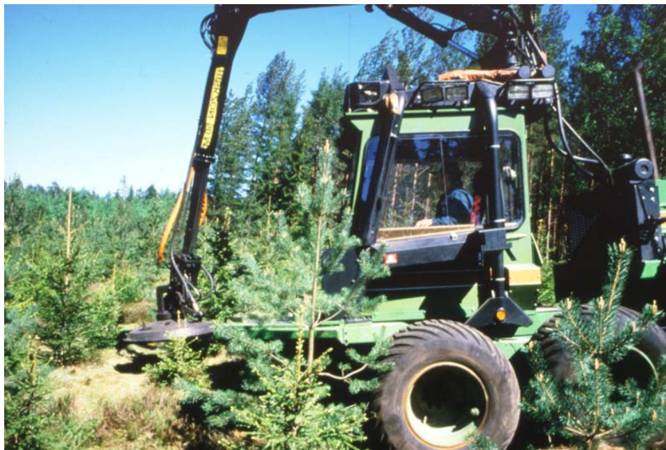
Figur R37 Skogstraktor med kranpetsmonterat rövningssaggregat från 1990-talet. Foto Iwan Wästerlund.
