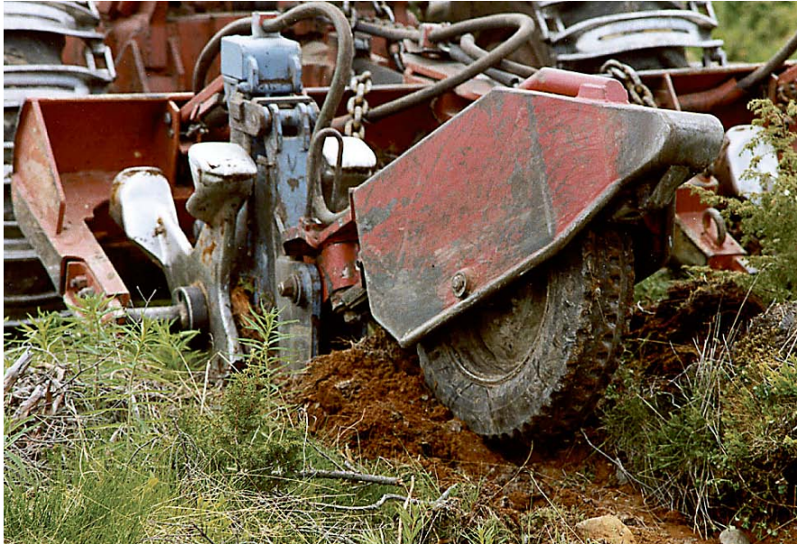
Figur S14 Maskinell mikropreparering och sådd efter ett såddanpassat Leno fläckmarkberedningsaggregat (långfläck). Fröna matas ut och hamnar på den mikropreparerade markytan efter mikroprepareringshjulet. Foto ForeCare AB.
