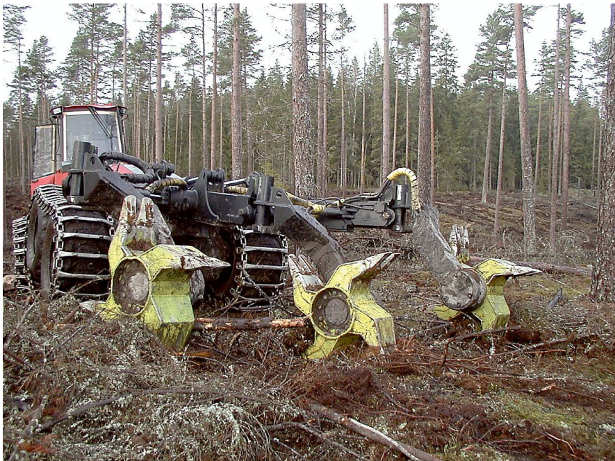
Figur S15 Variationsaggregat med intermittert körsätt (både högläggning och fläckning kan utföras). Vid markberedning för sådd görs en grund så kallad långfläck som är 3–4 meter lång. Foto ForeCare AB.
