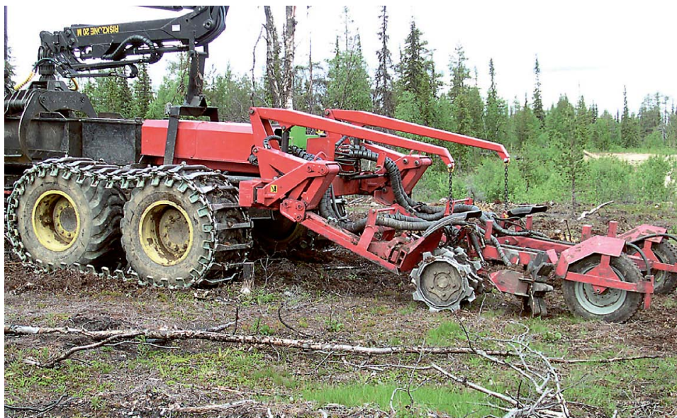
Figur S16 HuMinMix-aggregat för skonsam markberedning och mekaniserad sådd. Frässpår, långfläck och högläggning (för manuell plantering) kan utföras genom olika inställningar av det första fräshjulets rotationshastighet och rotationsriktning. Det vingförsedda andra hjulet reglerar tjockleken och finfördelningen på det skapade substratet. Frö matas ut bakom mikrorepareringshjulet (det tredje hjulet). Såddapparaten är monterad längst bak på basmaskinen. Foto Thomas Bergsten.
