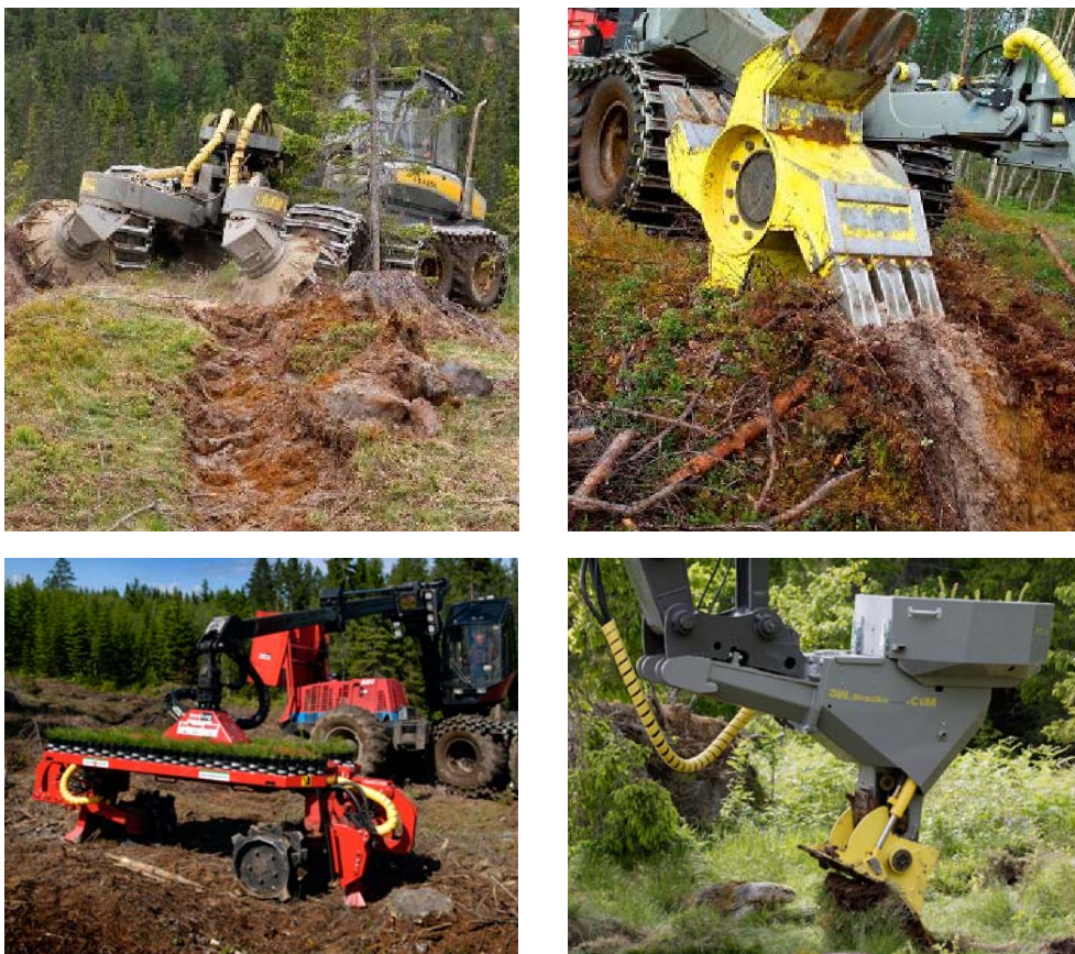
Figur PL17 Fyra exempel på markberedningsaggregat. Harv (Bracke) och högläggare (Komatsu Swelog) (ovan) är dragna aggregat. Ecoplanter (vänstra) och Bracke Planter (högra) är kranspetsmonterade och planterar i samband med markberedningen. Foto: Respektive tillverkare.
