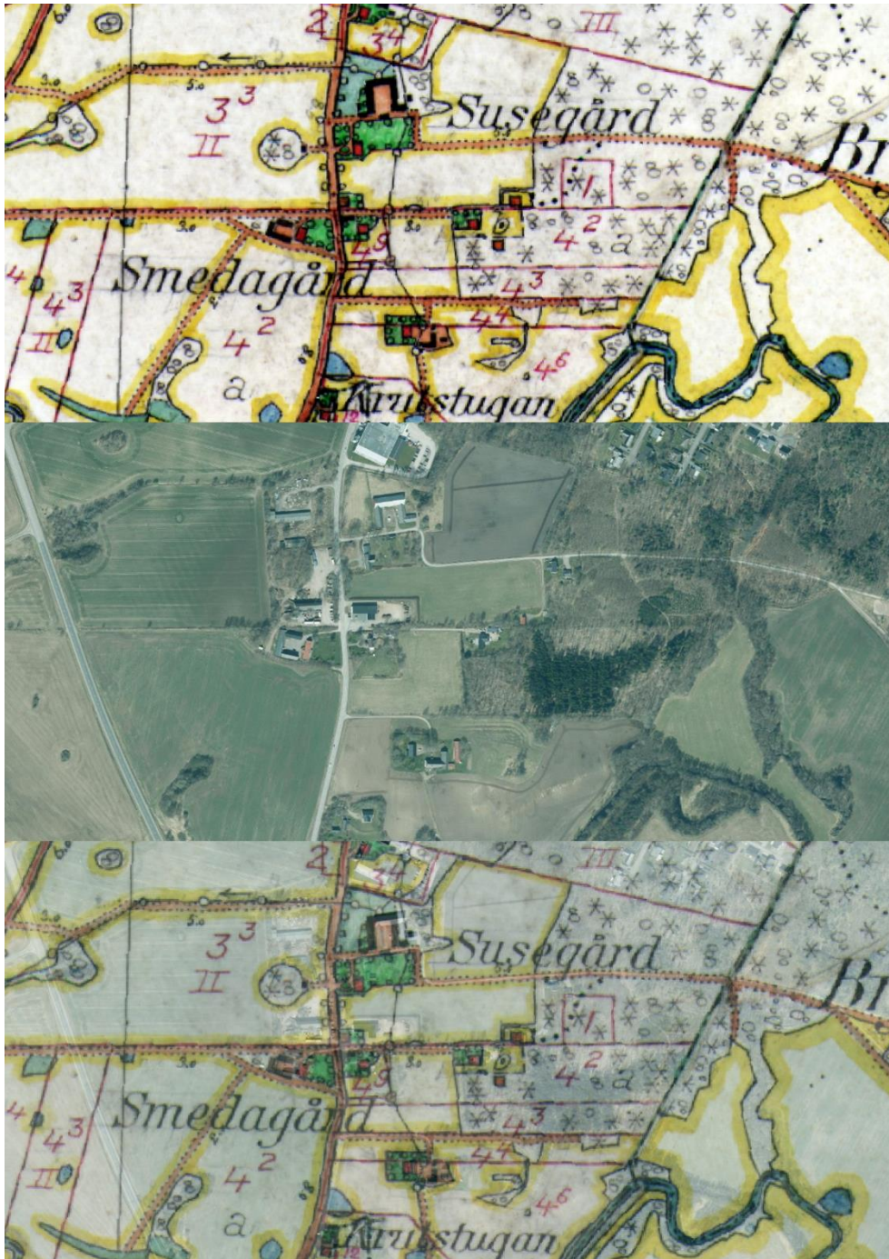
Figur 11. Kartan som har justerats enligt nio hörnkontrollpunkter jämfört med ortofotot. Bilden längst ned visar kartan ovanpå ortofotot med 50% genomskinlighet. Hus i kartan ligger ungefär 7 m förskjutna.
